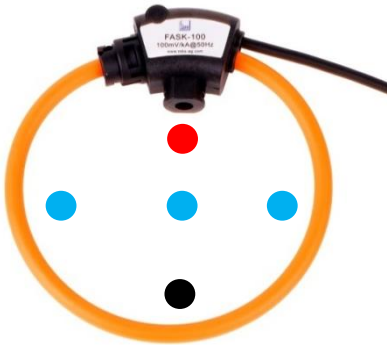
Abbildung 5: Primärleiterposition mit den typischen Fehlerwerten
